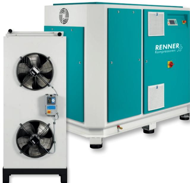
Die Baureihen RSW und RSWF wurden für die wirtschaftliche Erzeugung ölfreier Druckluft im Leistungsbereich von 18,5 bis 120 kW entwickelt. Wasser ersetzt Öl bei Kühlung, Schmierung und Abdichtung.
